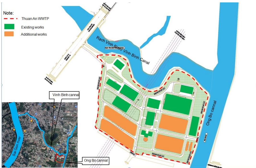
Hình 1.6. Mặt bằng nhà máy XLNT Thuận An
